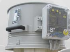
Sistema automatico di pulizia filtro con contro corrente d'aria (CCA)
