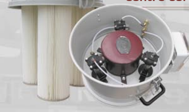
Sistema automatico di pulizia filtro con contro corrente d'aria (CCA)
